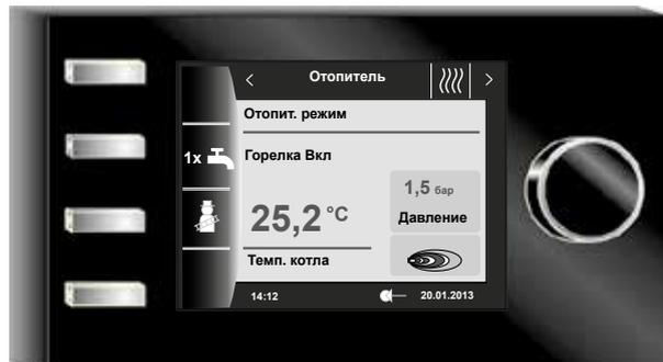
BM-2 (модуль управления) обменивается данными по шине eBus со всеми подсоединенными дополнительными модулями и с теплогенератором.
