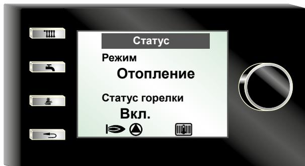
Модуль AM используется только в качестве модуля индикации на теплогенераторе. Возможно настройка и отображение специфических параметров и значений теплогенератора.
