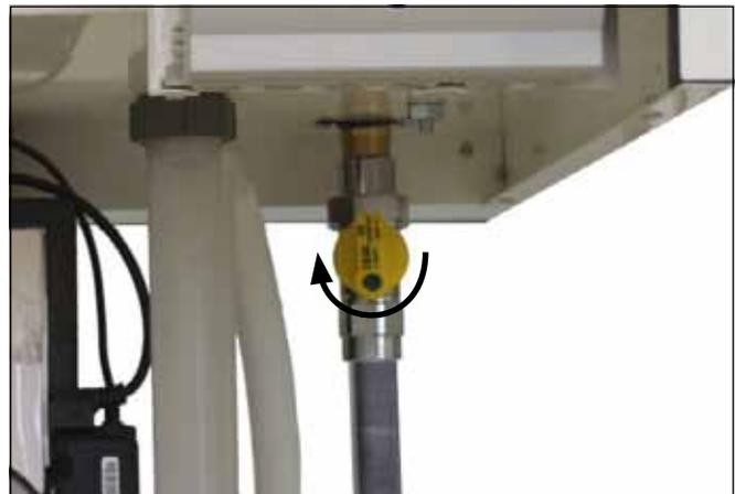
Рис.: Подключение газа
