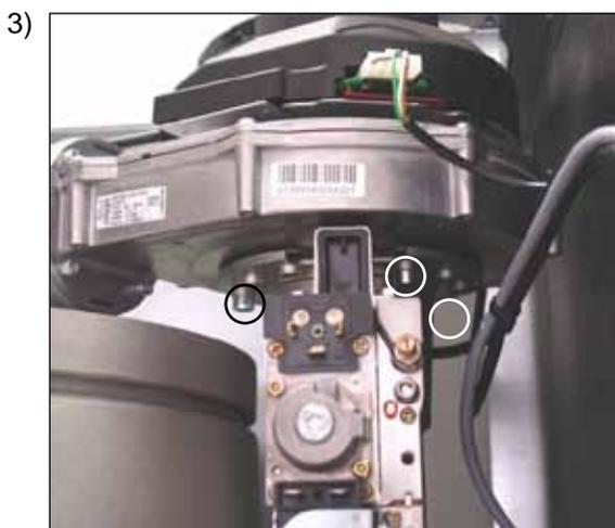
Отсоединить смешивательную камеру от вентилятора (отвинтив 3 винта с внутренним шестигранником 5 мм), в случае необходимости отсоединить воздухозаборный патрубок
