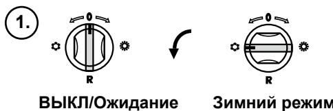
При установке рабочего выключателя на «Зимний режим» установка запускается и работает с **максимальной мощностью нагрева**.
