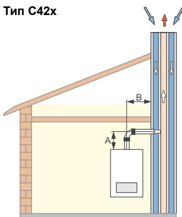
Соединение с воздуховодом/дымоходом (LAS) (забор воздуха из атмосферы), концентрическая система 60/100 мм
