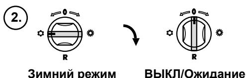
При установке рабочего выключателя на «ВЫКЛ/Ожидание» установка регулируется до **минимальной мощности**.
