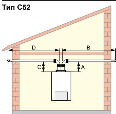
Соединение с дымоходом и приточным воздуховодом через наружную стену или крышу (забор воздуха из атмосферы), система 80/80 мм
