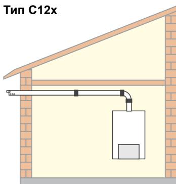
Соединение с наружной стеной (забор воздуха из атмосферы), концентрическая горизонтальная система 60/100 мм, мин./макс. расчетная длина трубы = 0,3/4,0 м
