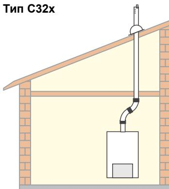
Проход через крышу (забор воздуха из атмосферы), концентрическая вертикальная система 60/100 мм, мин./макс. расчетная длина трубы = 0,3/4,0 м
