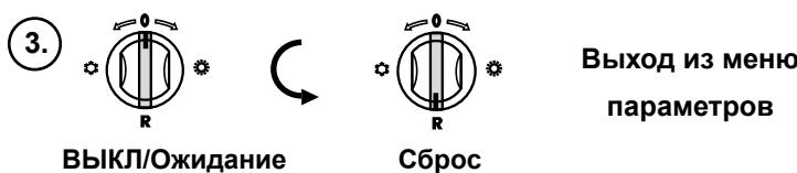
При установке рабочего выключателя на «Сброс» режим «Трубочист» завершается.
