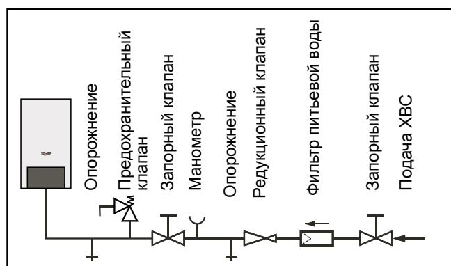
Рис. Соединение XBC согл. DIN 1988
