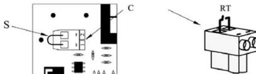
Рис. Штекерный разъем комнатного термостата
